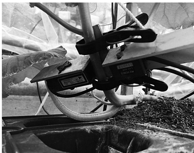
写真3. レーザーセンサによる茎径測定
